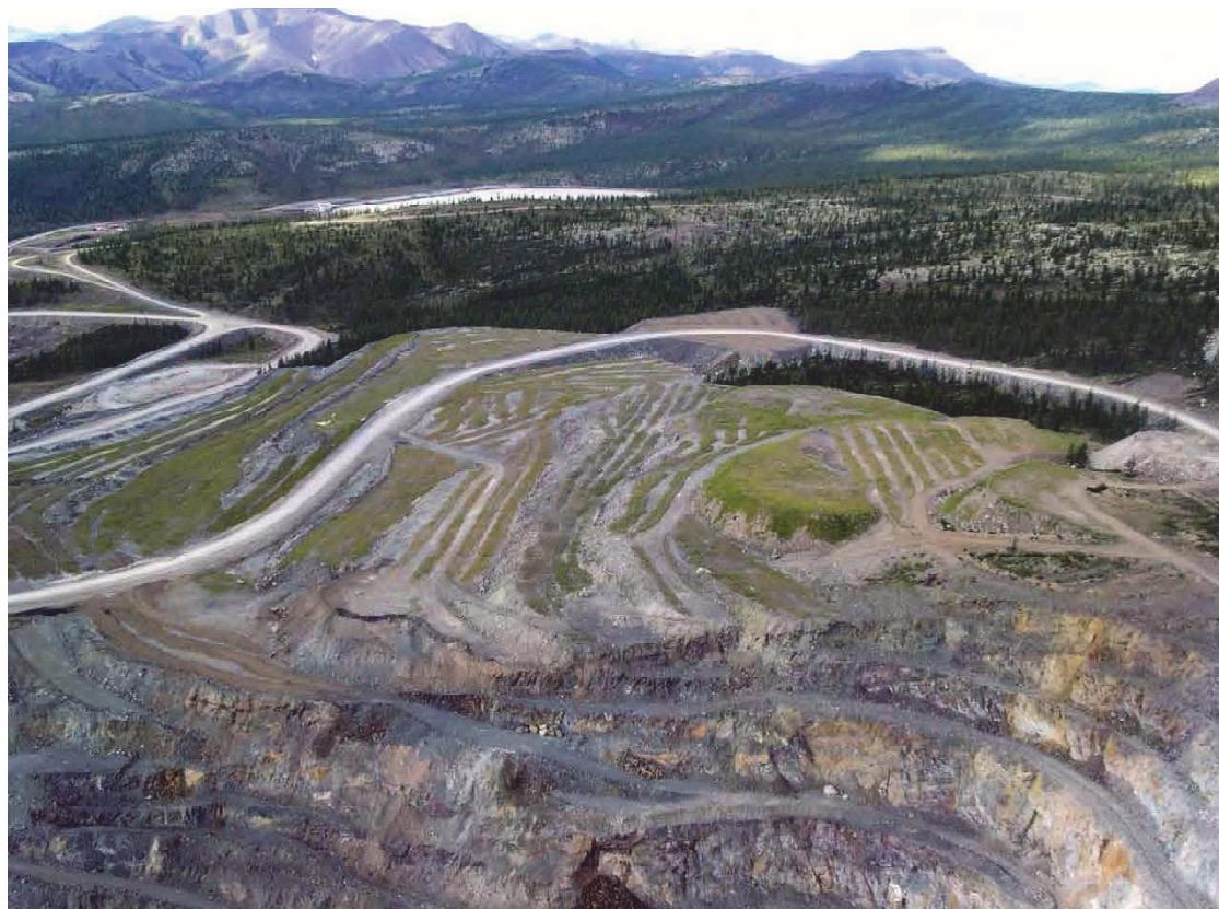
**Рис. 1.** Рекультивируемые техногенные образования на золоторудном месторождении Кубака (бассейн р. Омолон)
