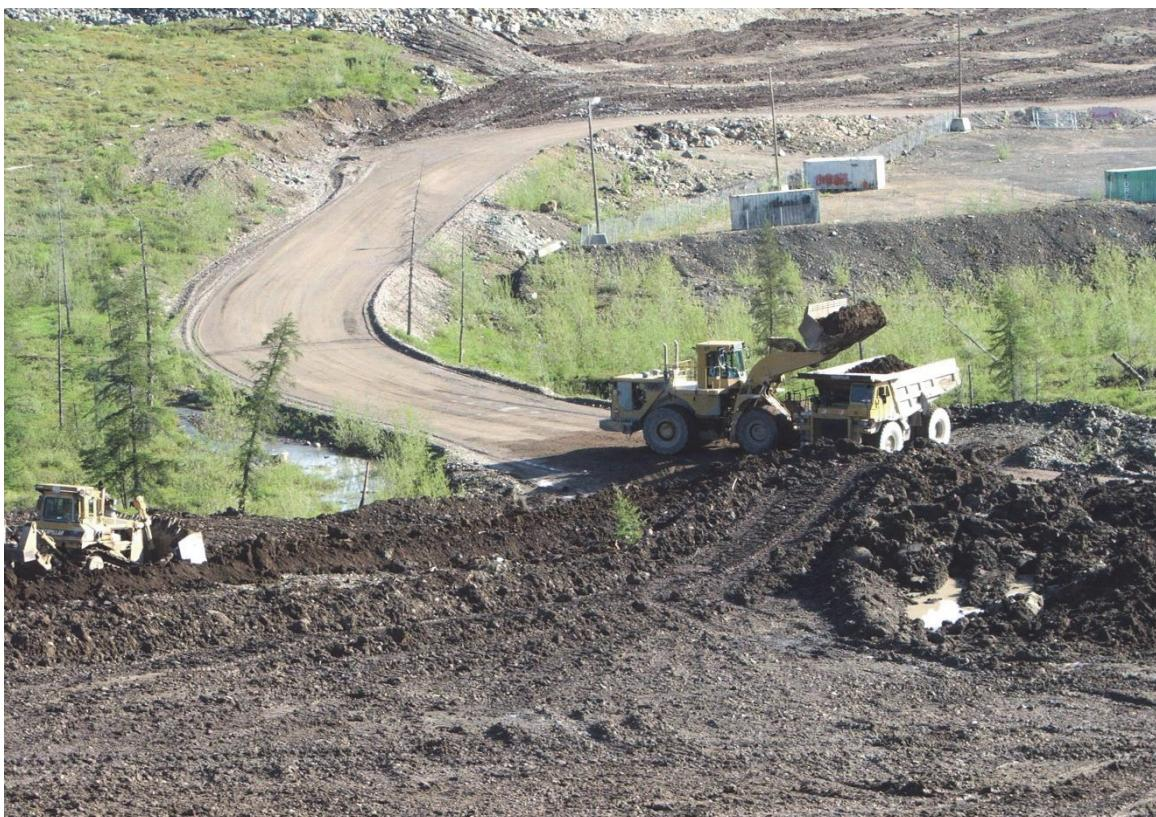
**Рис. 2.** Заготовка почво-грунтов для формирования корнеобитаемого поверхностного слоя на породных отвалах
