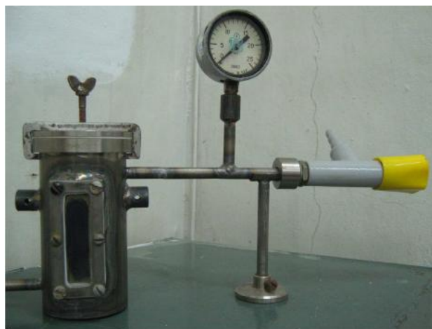
Рис. 1. Экспериментальная установка для проведения СВС
