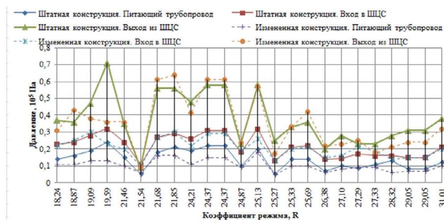
Рис. 14. Изменение пульсационного состояния насосного агрегата при различных компоновках сливных магистралей
