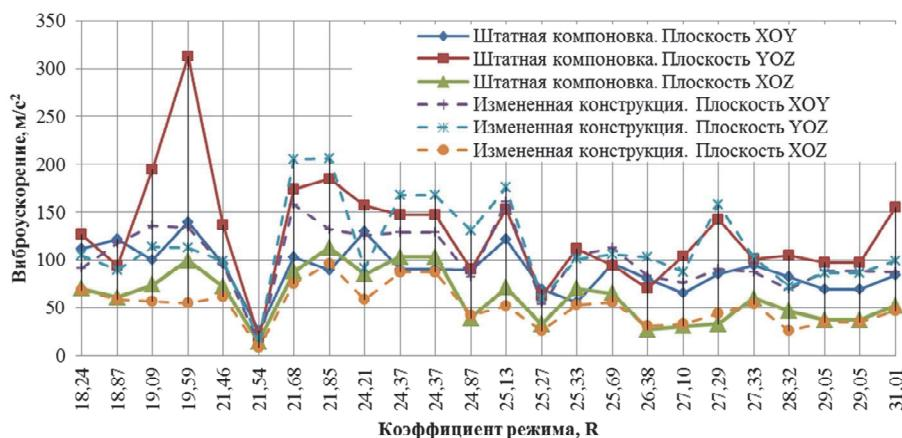
Рис. 13. Изменение вибрационного состояния насосного агрегата в различных плоскостях при различных компоновках сливных магистралей
