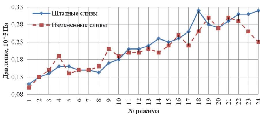
Рис. 7. СКЗ пульсаций давления на входе в ШЦС
