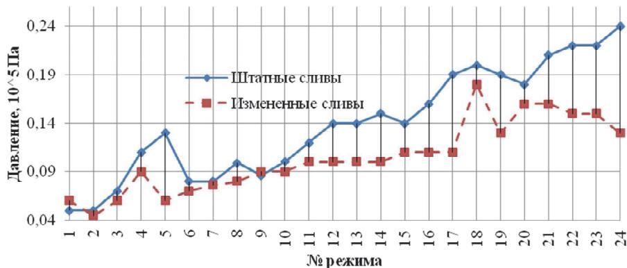
Рис. 6. СКЗ пульсаций давления в трубопроводе
