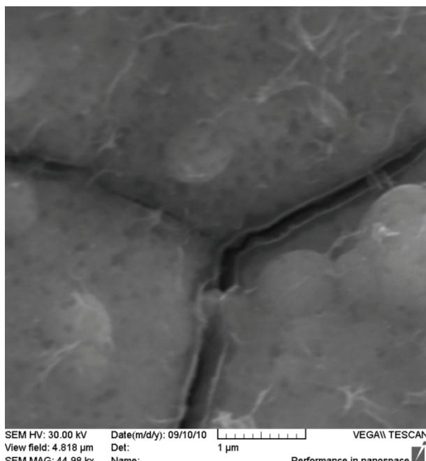
**Рис. 4.** Изображение характерной нанопоры канального типа шириной ~ 100 нм; увелич. х44980
