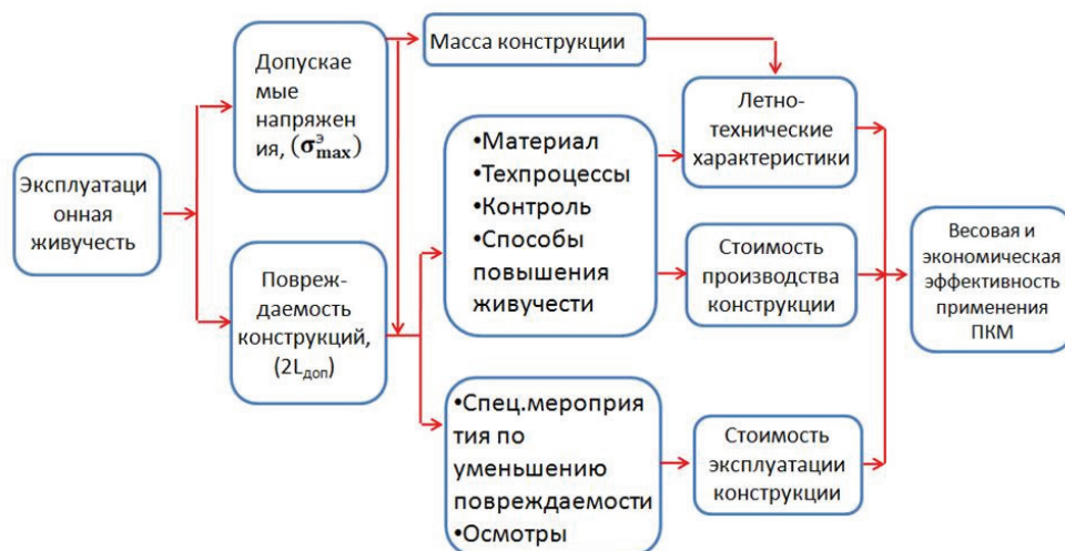
Рис. 5. Общая схема повышения эффективности применения ПКМ
