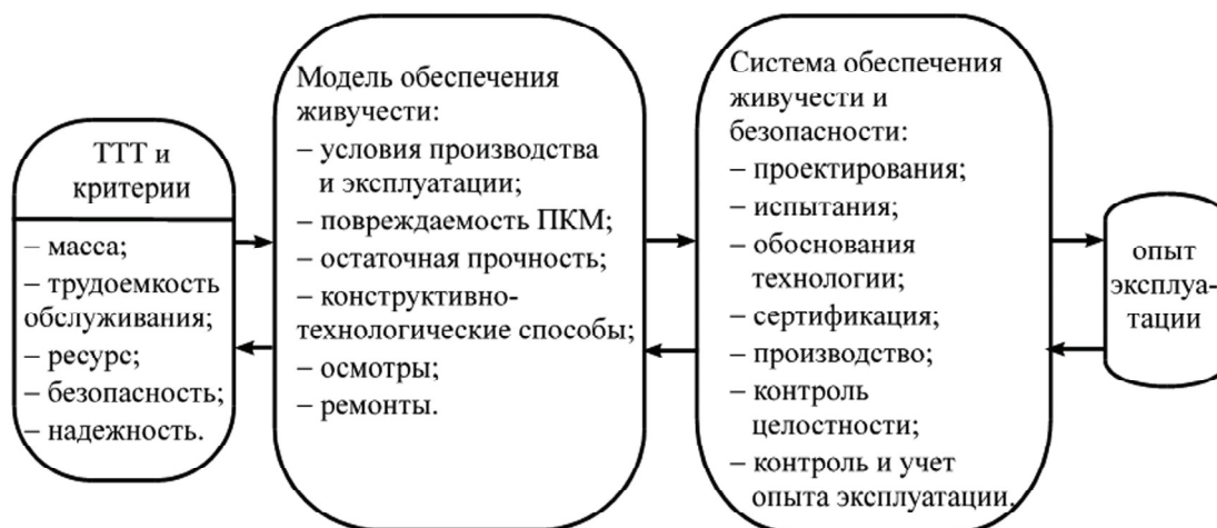
Рис. 9. Общая схема решения задачи конструктивно-технологического обеспечения живучести и безопасности авиаконструкций из ПКМ
