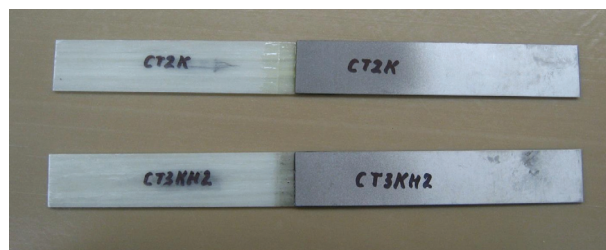
Рис. 3. Фотоизображение образцов для испытаний клеевого соединения элементов из стеклопластика и титанового сплава
