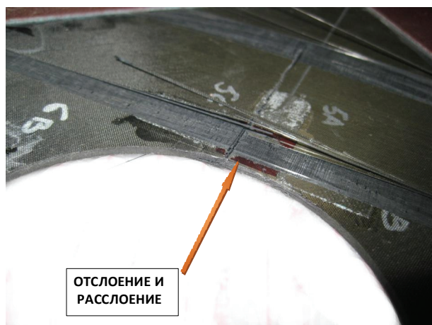
Рис. 7. Исходный образец после испытаний на потерю устойчивости при сдвиге
