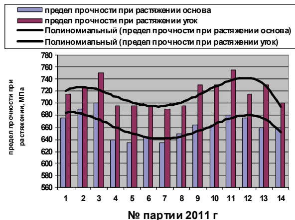
Рис. 5. Диаграмма замеров предела прочности при растяжении (основа, уток) листов органита 11ТЛ по 14 партиям, изготовленным в 2011 году
