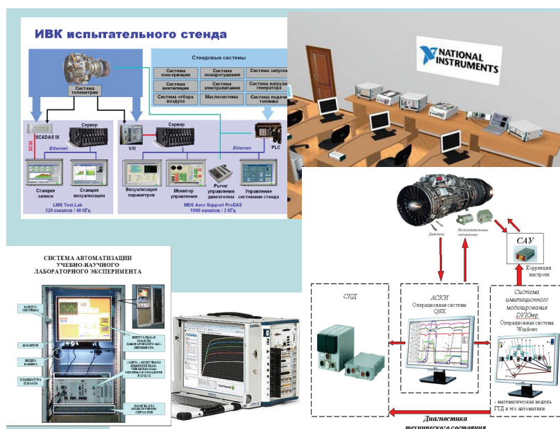
Рис. 9. Разработанные SCADA-приложения для автоматизации испытаний, управления, контроля и диагностики в эксплуатации ГТД (пример на основе программно-аппаратных средств National Instruments)
