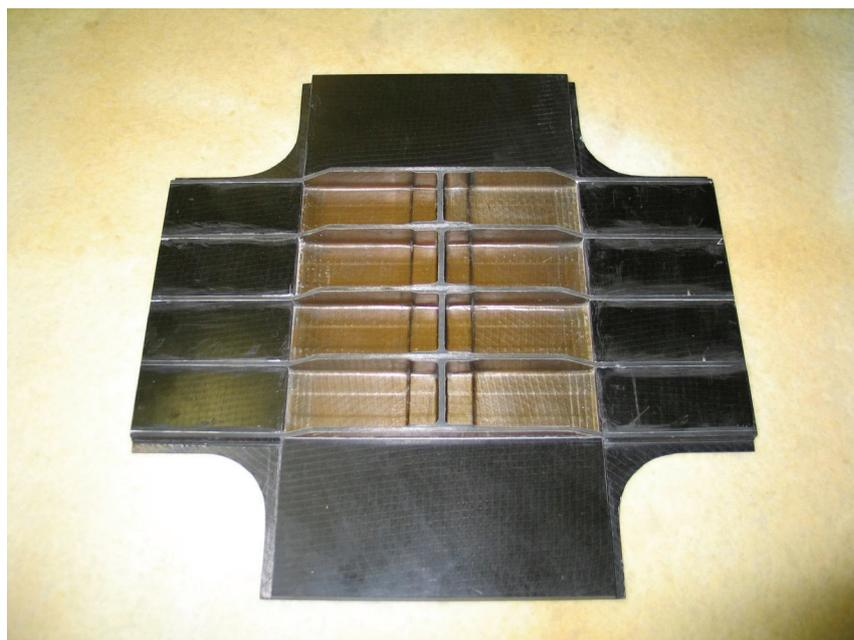
Рис. 2. Фрагмент композитной конструкции подкрепленной панели интегрального типа
