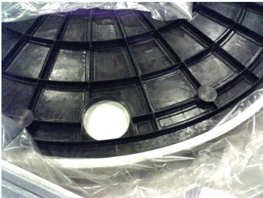
Рис. 1. Фрагмент размеростабильной углепластиковой интегральной конструкции центрального зеркала  $D=2,6$ м радиотелескопа «Спектр-Р»
