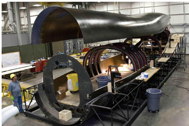
Рис. 2. Изготовление секции фюзеляжа из ПКМ
