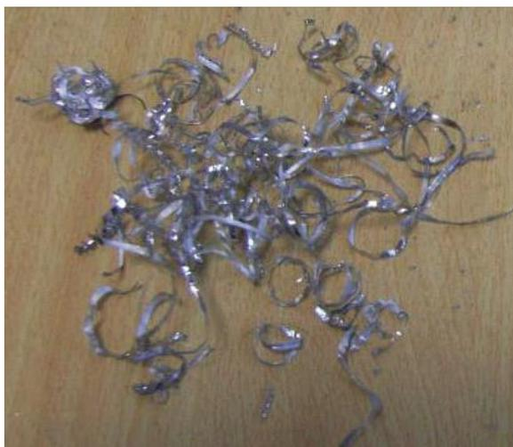
Фото 5. Стружка при постоянной подаче
