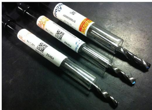
**Фото 7.** Сверло твёрдосплавное Ж 6,35 мм с цилиндрическим резьбовым хвостовиком и маслоканалами для подачи СОЖ компании Sandvik-Precor (США)
