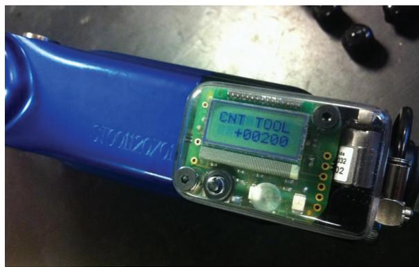
**Фото 4.** Счётчик циклов для своевременной замены режущего инструмента
