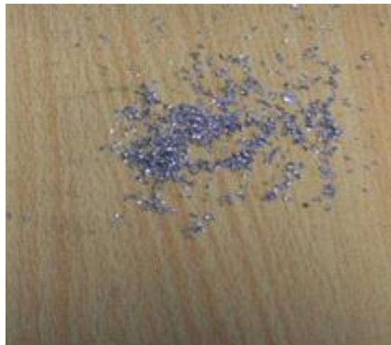
Фото 6. Стружка при импульсной («клюющей») подаче
