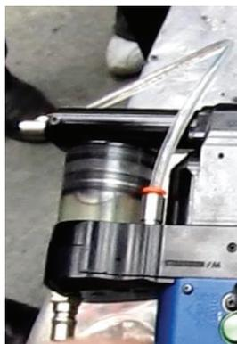
**Фото 3.** Система подачи СОЖ в зону сверления через режущий инструмент
