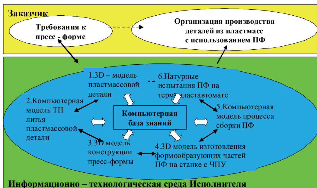
Рис. 3. Роль и место системы взаимосвязанных компьютерных моделей при проектировании и изготовлении ПФ в условиях информационно-технологической среды
