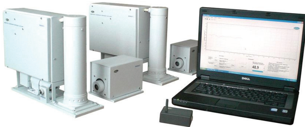
Рис. 4. Внешний вид установки автоматизированной системы технологического контроля массового процентного содержания связующего в препреге АСК-2
