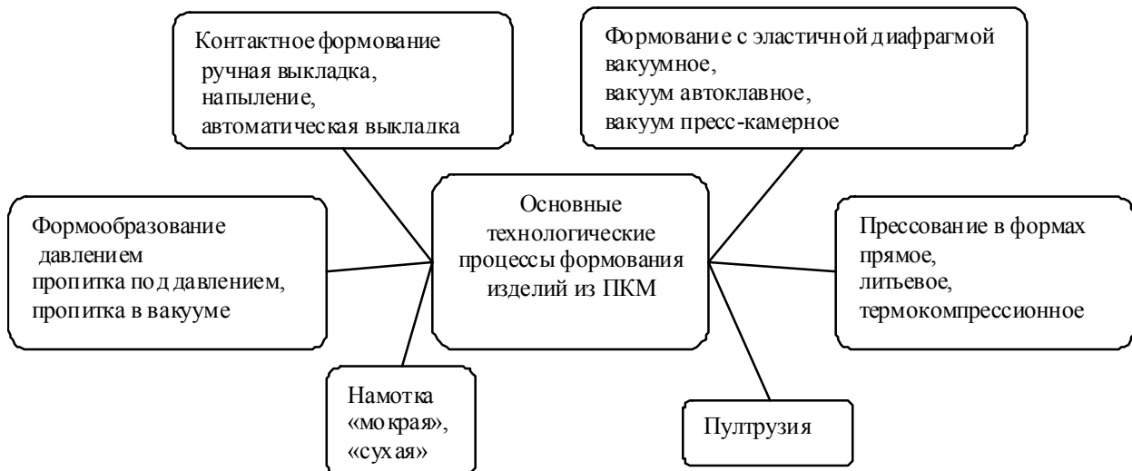
Рис. 1. Основные технологические процессы формования деталей из ПКМ
