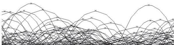
Рис. 6. Модель профиля рабочей поверхности шлифовального круга
