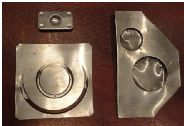
Рис. 5. Детали с неполным отделением отхода из-за притупления режущих кромок вырубного инструмента
