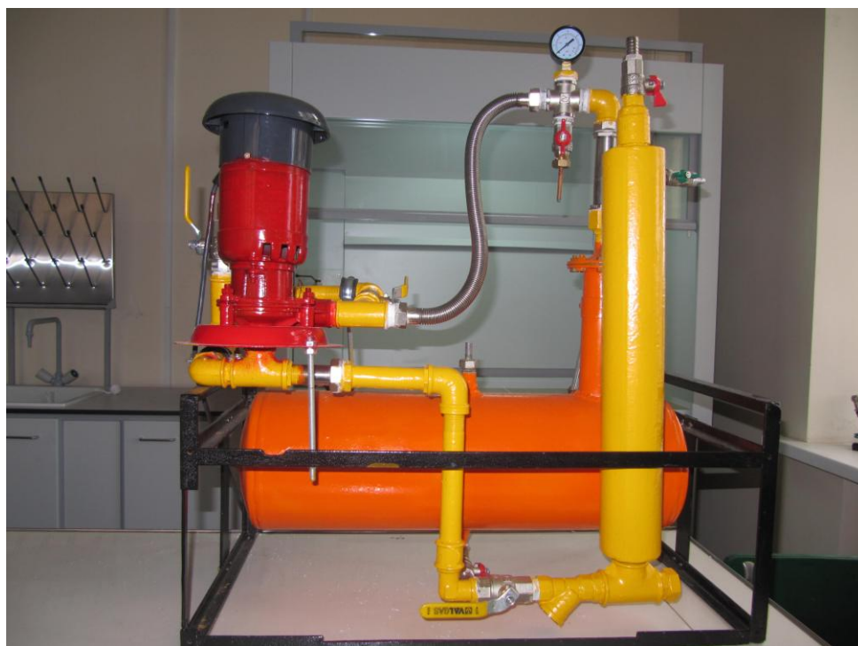
Рис. 5. Опытная лабораторная установка утилизации отработанных ёмкостей хранения одоранта
