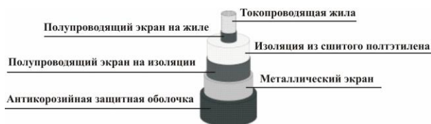
Рис. 9. Схема элементов, составляющих кабель: 1 – токопроводящая жила для прохождения тока; 2 – полупроводящий экран на жиле для сглаживания скачков напряженности ЭП между жилой и изоляцией; 3 – изоляция из сшитого полиэтилена для электрической изоляции жилы; 4 – полупроводящий экран на изоляции для сглаживания скачков напряженности ЭП между изоляцией металлическим экраном; 5 – металлический экран для экранирования ЭП кабеля; 6 – антикоррозионная защитная оболочка для изоляции кабеля от окружающей среды
