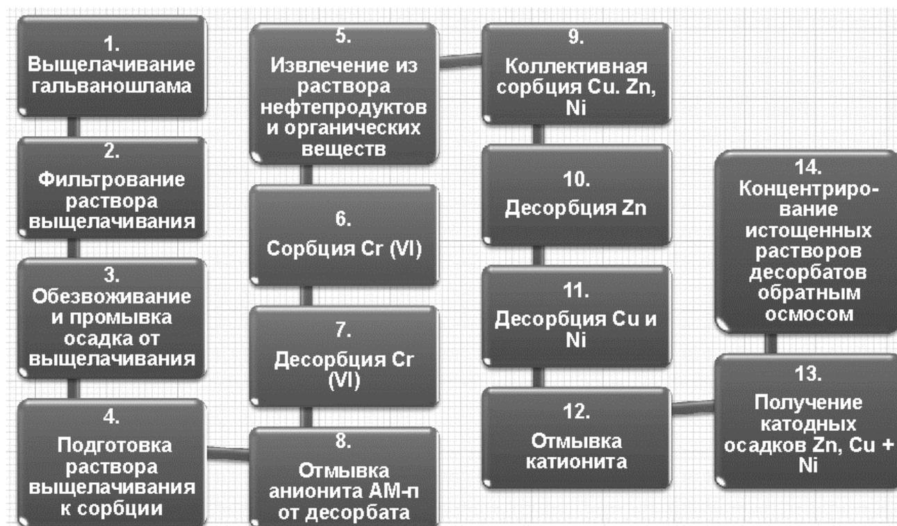
**Рис. 1.** Функциональная схема обезвреживания и утилизации гальваношламов сложного состава
