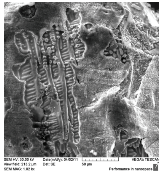
Рис. 3. Изображение сообщающихся с внешней поверхностью образцов пор, сформировавшихся в сплаве Л62 в эвтектических прослойках на границах дендритов; увелич. x1020
