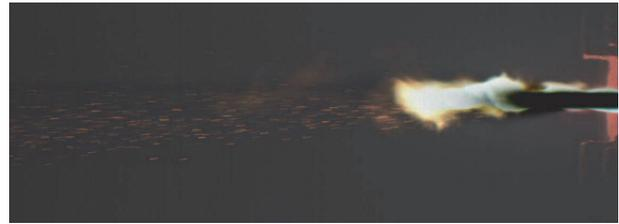
**Рис. 6.** Экспериментальное исследование сепарации частиц в плазменной струе
