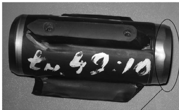
Следы абразивного износа кромки
