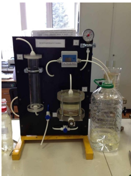
Рис 1. Общий вид лабораторной сорбционной установки
