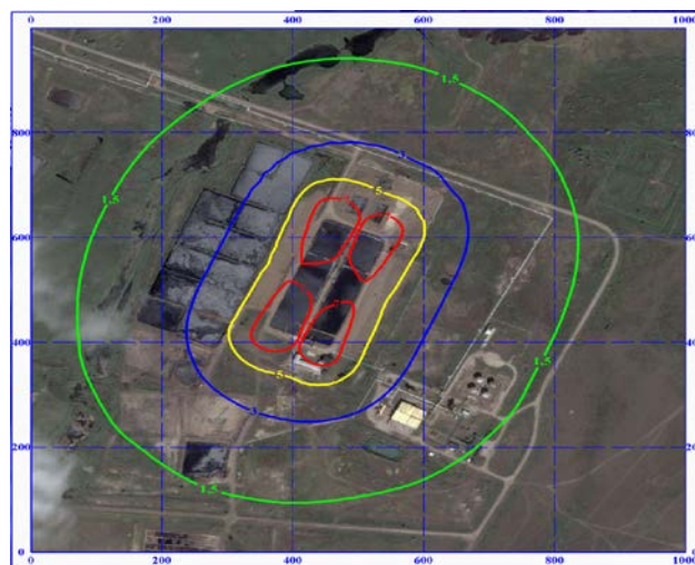
Рис. 3. Определение полей индивидуального риска ( \times 10^{-5} ) при расчёте распределительной функции по методике ТОКСИ. Масштаб 1:8000
