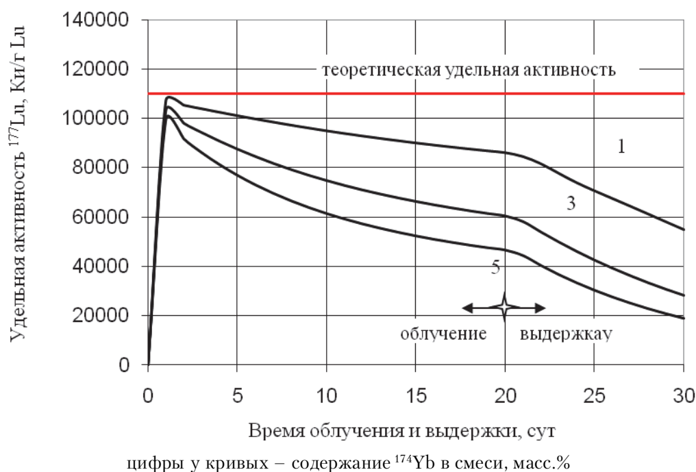
Рис. 6. Зависимость удельной активности ^{177}\text{Lu} от времени облучения и послереакторной выдержки (облучение смеси ^{174}\text{Yb} и ^{176}\text{Yb} в нейтронном потоке \Phi = 2 \times 10^{15} \text{ см}^{-2} \text{ с}^{-1} )
