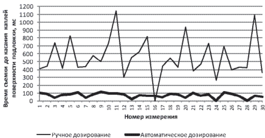
Рис. 3. Графики длительности периодов съёмки неинформативных кадров при ручном и автоматическом дозировании
