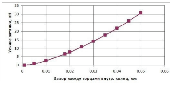
Рис. 7. Зависимость усилия затяжки подшипника 286896 от зазора между внутренними кольцами
