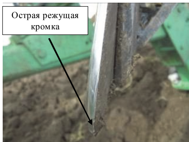
Рис. 5. Внешний вид лемеха плуга с защитным покрытием после 120 Га наработки. Износ 3,1 мм, отсутствие затупления режущей кромки
