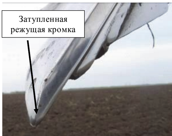
Рис. 4. Внешний вид лемеха плуга без защитного покрытия после 120 Га наработки. Износ 8,4 мм, затупление режущей кромки
