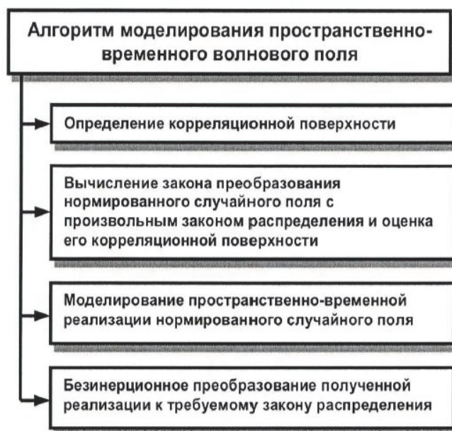
Рис. 2. Последовательность операций при моделировании динамики внешней среды
