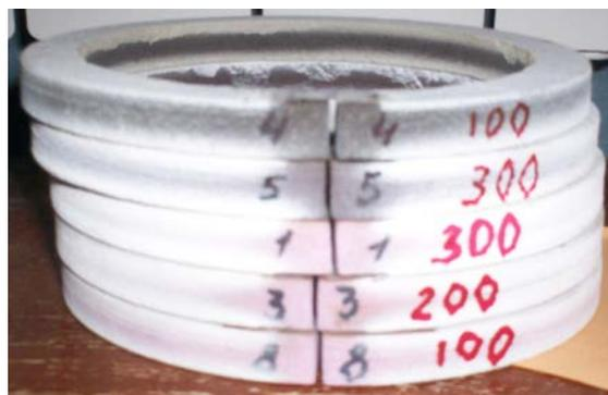
Рис. 3. Общий вид образцов шлифовальных кругов после напыления
