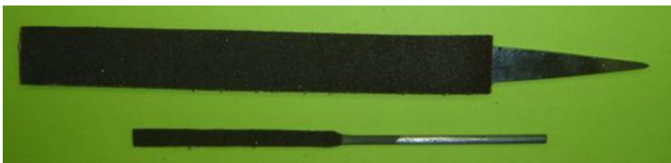
Рис. 6. Напильник и надфиль с рабочей поверхностью, полученной наклеиванием металлизированной абразивной бумаги
