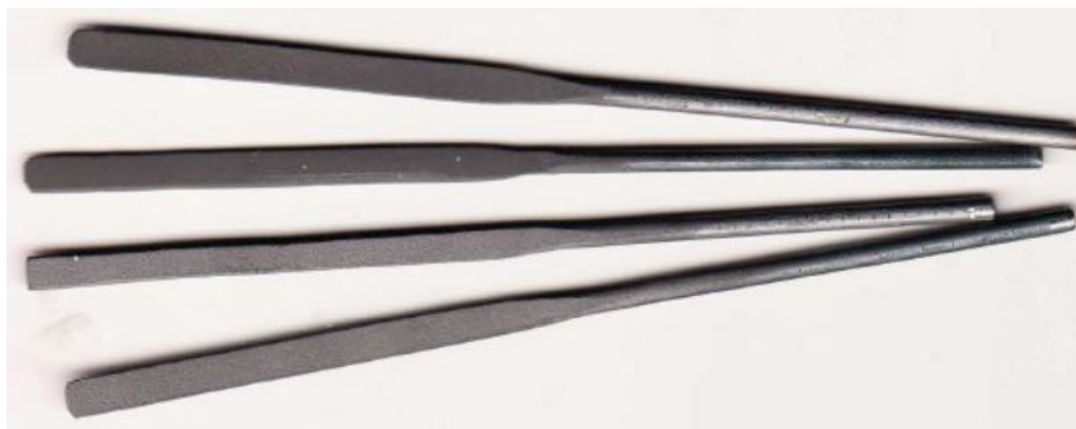
Рис. 2. Надфили с абразивным твердосплавным покрытием
