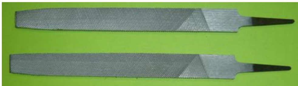
Рис. 3. Нанесение на рабочие поверхности напильника износостойкого хром-алмазного покрытия
