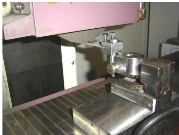
Рис. 3. Измерительный комплекс для определения силовых характеристик шлифования
