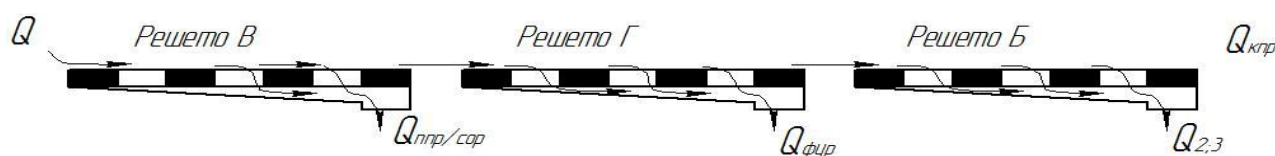
Рис. 2. Схема трехрешетного одноярусного модуля, реализующая технологический процесс сепарации семян зерновых. Решета «В», «Г», «Б» выполнены как из листового металла, так и из полимерного материала на основе СВМПЭ
