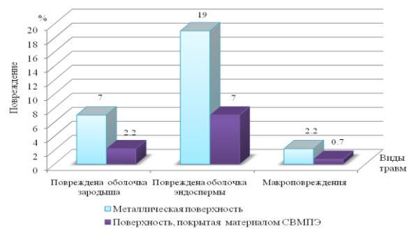
Рис. 8. Сравнительный анализ основных повреждений семян ячменя при проходе зерна в наклонной камере комбайна на различных типах покрытий
