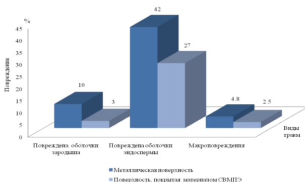
Рис. 7. Сравнительный анализ основных повреждений семян пшеницы при проходе зерна в наклонной камере комбайна на различных типах покрытий
