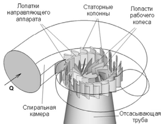
Рис. 3. Расчетная область для определения  $F_1$  и данных для течений в лабиринтах
