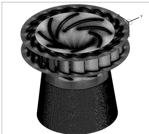
Рис. 3. Расчетная сетка, используемая в постановке 2 – «+»
