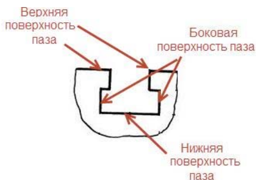
Рис. 6. Конструктивные элементы паза
