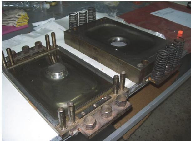
**Рис. 3.** Пресс-форма для формования образцов трёхслойной сотовой панели по ускоренной технологии (пуансон и матрица)
