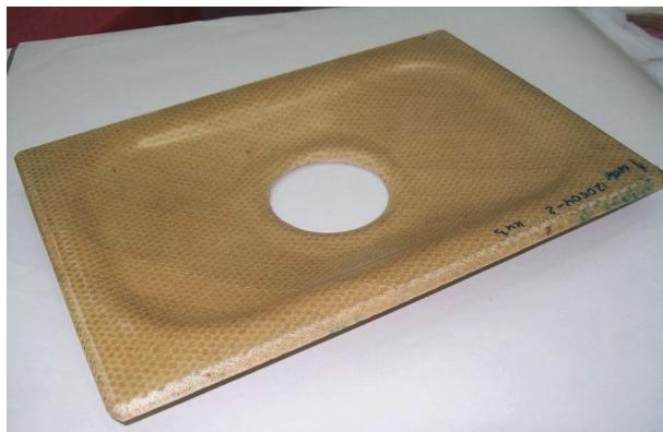
**Рис. 5.** Образец трёхслойной сотовой панели с заделанными по контуру торцами, изготовленный по ускоренной технологии формования
