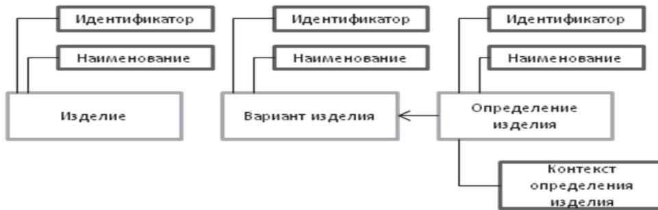
Рис. 4. Упрощенная схема объектов, идентифицирующих изделие
