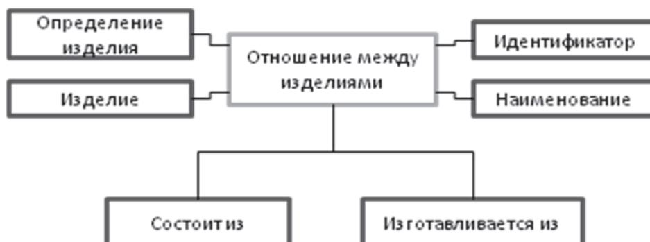
Рис. 5. Упрощенная схема объектов, описывающих отношения между изделиями
