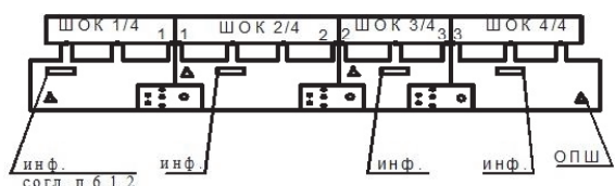
Рис. 2. Схема стыковки разъемного шаблона
