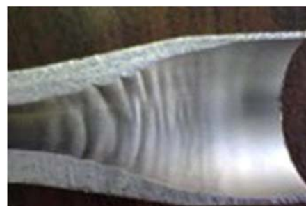
Рис. 2. Заготовка, изготовленная из алюминиевого сплава Д16, разрезанная в зоне, подлежащей контролю
