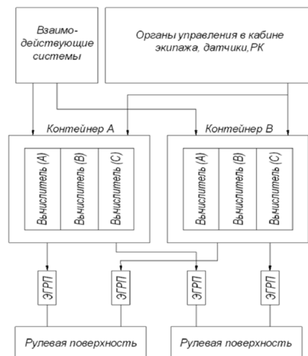
Рис. 1. Принципиальная схема развития СУР самолета Ту-204 на примере одного канала управления
