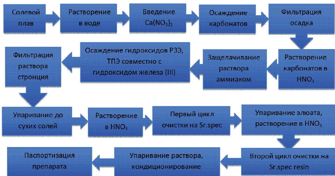
Рис. 2. Схема процесса переработки солевого плава
