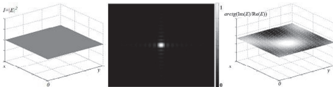
Рис. 1. Однородная генерация при \delta = -3 , r = 20 , \sigma = 1 , \gamma = 0.01 , a=0.005 : профили интенсивности в ближней (а), дальней зоне (б) и распределение фазы (в)
