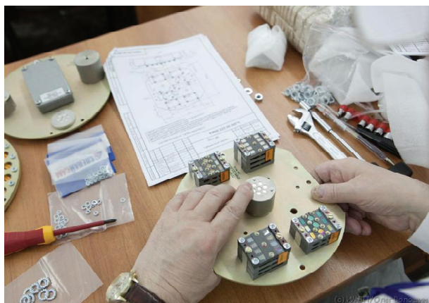
Рис. 7. Монтаж Сборок КАРБОН на плату полезной нагрузки
