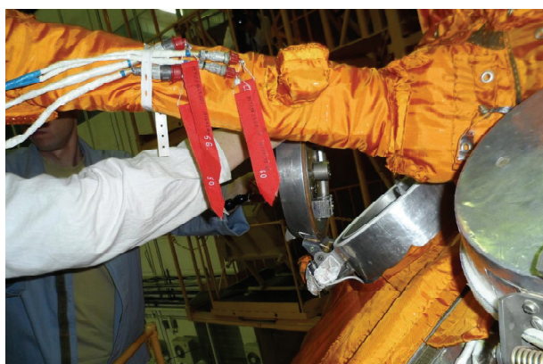
Рис. 9. Установка платы полезной нагрузки с научной аппаратурой КАРБОН в контейнер научной аппаратуры КА «БИОН-М» № 1
