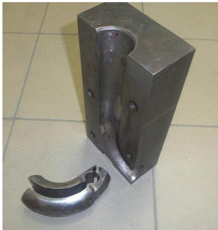
**Рис. 5.** Полуматрица для изготовления отвода и составная жесткая внутренняя оправка
