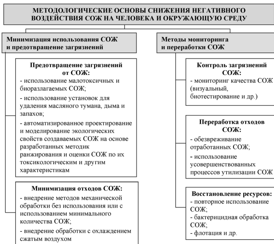
Рис. 1. Методы снижения негативного воздействия СОЖ
