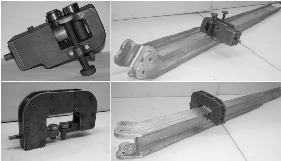
Рис. 4. Разработанный инструмент для обработки ребер (вверху) и полотна (внизу) деталей раскаткой роликами
