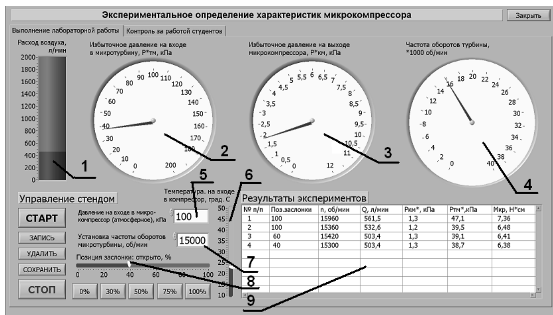
Рис. 7. Внешний вид окна программы управления стендом и отображения результатов [1]
