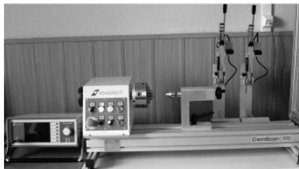
Рис. 2. Измерительный стенд CamScan 100-2LD в комплекте с анализатором шумов Баркгаузена Rollscan 300
